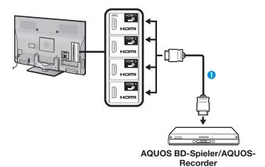
1 HDMI-geprüftes Kabel (im Fachhandel erhältlich)
