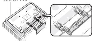
4 Setzen Sie die mittleren Schrauben auf die Löcher in der TV-Rückseite an und ziehen Sie sie fest.
