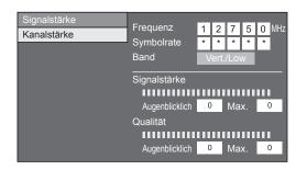
Passen Sie die Position und Ausrichtung der Antenne so an, dass Sie die größtmöglichen Werte für "Signalstärke" und "Qualität" erhalten.
