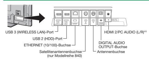
\*3 Für die Buchsen HDMI 2 und PC kann dieselbe Toneingangsbuchse verwendet werden (HDMI 2/PC AUDIO (L/R)). Hierfür muss aber im Menü "Audiowahl" der richtige Punkt gewählt werden (Näheres siehe Seite 41).
