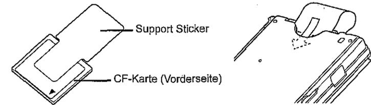
Wenn Sie eine CF-Karte mit einem Support Sticker in den Erweiterungssteckplatz eingesetzt haben, müssen Sie das Ende des Stickers in den Schlitz zwischen der Rückseite der Karte und dem Gerät stecken (siehe Abbildung).
