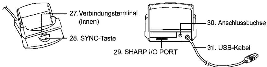
27. **Verbindungsterminal:** Ermöglicht die Verbindung mit dem SHARP I/O PORT des SL-5500G.
