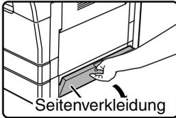
Ziehen Sie am Griff der Seitenverkleidung, um sie zu öffnen.
