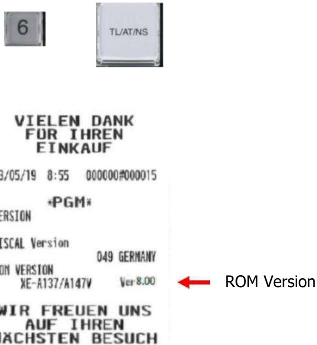
Auf dem Ausdruck steht unter der Zeile „ROM VERSION“ das Modell und die aktuell installierte ROM Version.
