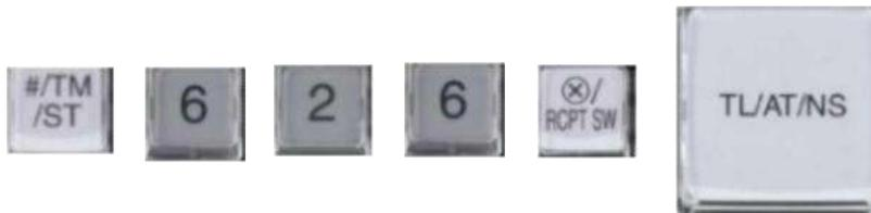
Automatischer Ausdruck der „PUK/PIN“ Informationen und der „Amtlichen Formulardaten“ für die Registrierung bei der zuständigen Finanzbehörde nach erfolgter Aktivierung.
