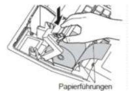
d) Schneiden Sie das überschüssige Papier ab und bringen Sie die Druckwerkabdeckung wieder an. Kontrollieren Sie den korrekten Papierlauf durch Drücken der Papieviorschubtaste
